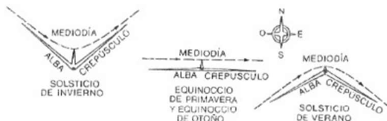
FIGURA 1. — Movimiento de la sombra del gnomon en las latitudes boreales medias durante las diversas estaciones del año. A la salida y a la puesta del sol, la sombra se alarga instantáneamente hasta el infinito y su extremo “se junta” con la línea representada en trazo discontinuo. Entre el alba y el crepúsculo, la extremidad de la sombra se mueve lentamente a lo largo de dicha línea; en el mediodía, la sombra siempre está dirigida hacia el norte exacto.
